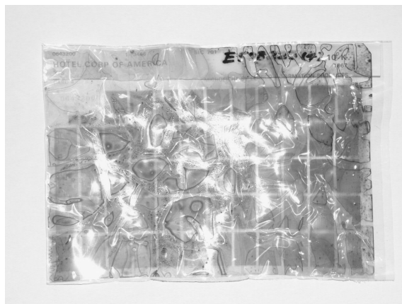
図 10 ジアゾフィルムの劣化
